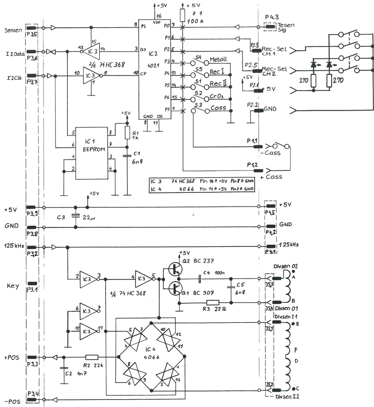
IC 3 74 HC 368 Pin 16 = +5V Pin 8 = GND
